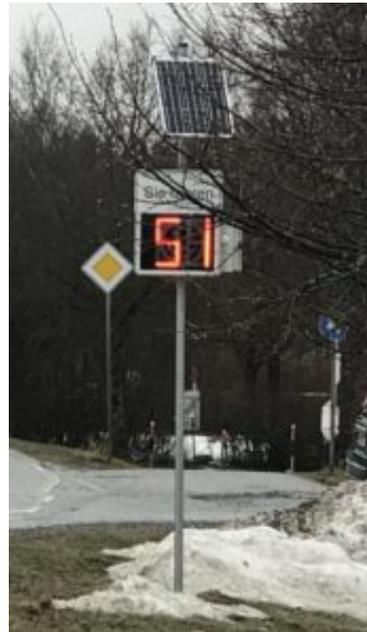
Hier ein Beispiel einer Geschwindigkeitsanzeige-Tafel mit Solarpanel; die Darstellung erfolgt in den Ampelfarben Rot, Gelb und Grün je nach Geschwindigkeit. Die Hersteller ermöglichen über eine Smartphone-App die Konfiguration und Datenübertragung.
